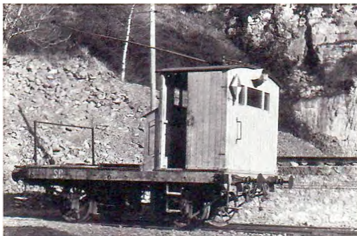
Fig25 - Tracteur électrique qui pouvait transporter des charges de 7,2 tonnes
